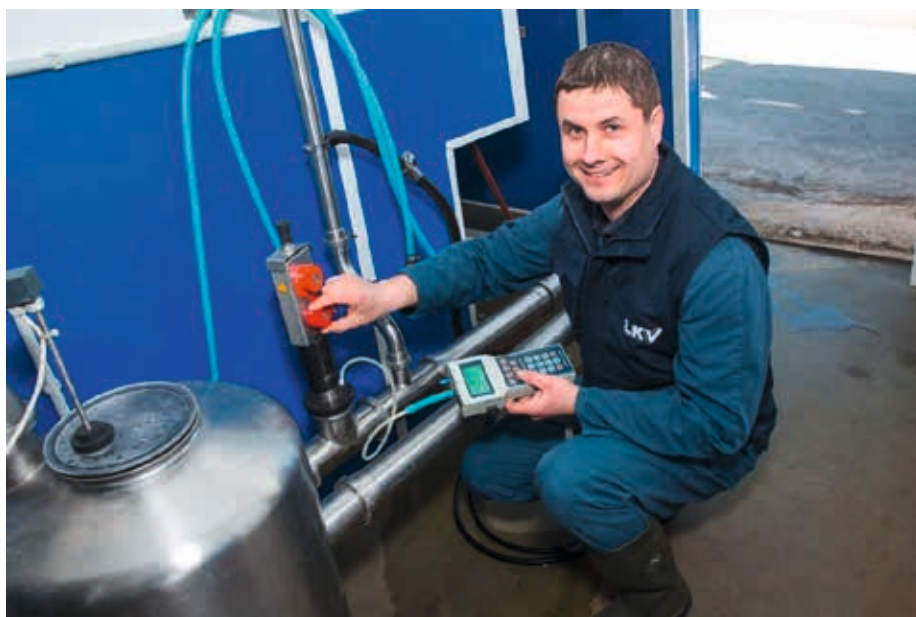
Melktechnikspezialberater André Nolden bei der Vakuummessung
